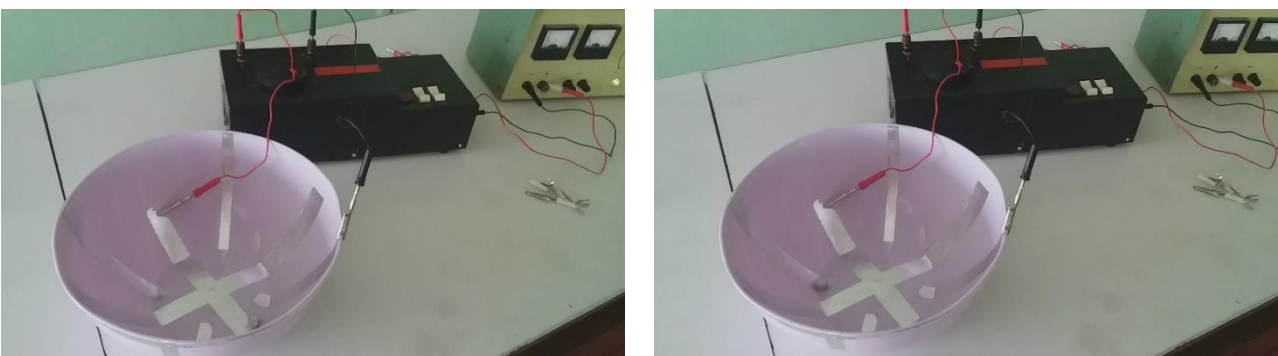
Рисунок 4. Натурна демонстрація принципу роботи циклотрона: а) початковий момент; б) прискорення «частинки» під дією електричного поля.
