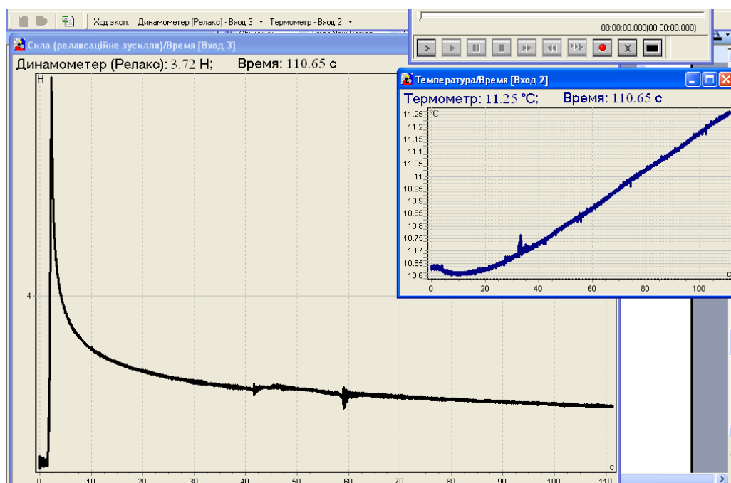
Рис. 2 – Вікно програми при дослідженні релаксаційного напруження та релаксаційного розслаблення зразка з одночасною фіксацією зміни температури в середині зразка
