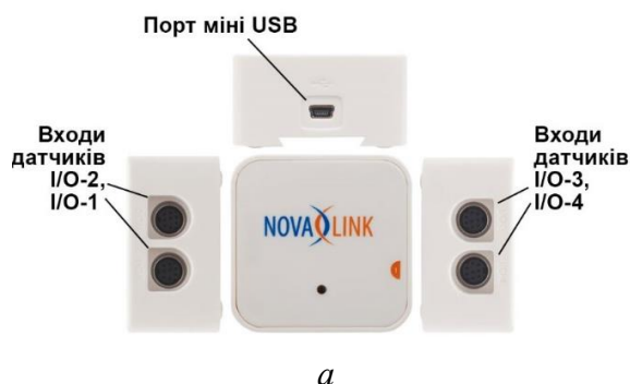
Рис. 12. Підключення датчиків до реєстратора даних NOVA Link
